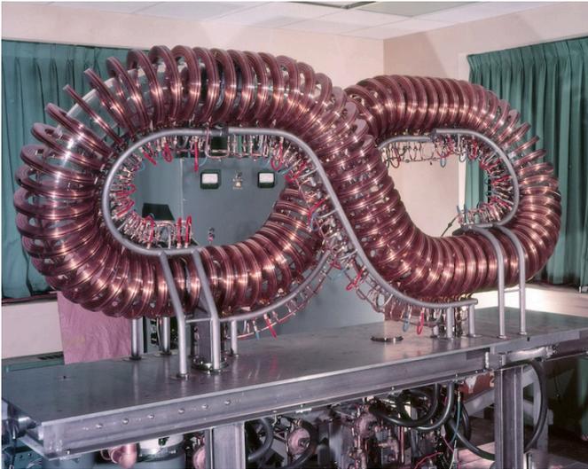
Abbildung 2.7. Der Modell B-2 Stellarator mit seiner charakteristischen 8-förmigen Gestalt. Quelle: PPPL.
